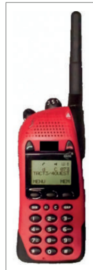
Fig. 152. Terminal utilisé pour le réseau Antares (INPT) 420 .
