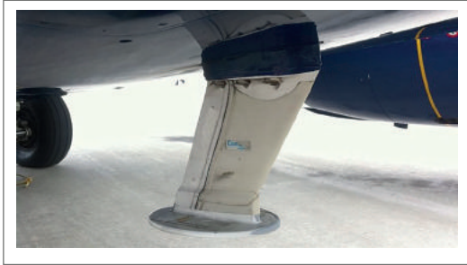
Fig. 108. Antenne de communication installée sous l'appareil 313 .
