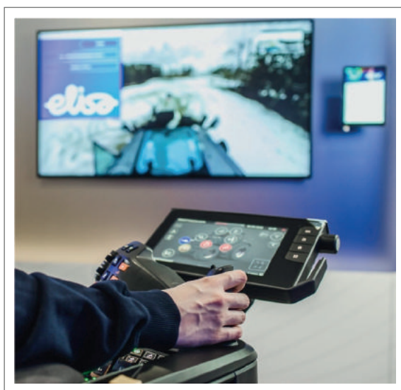
Fig. 177. Commande à distance d'un tracteur Valtra avec la 5G d'Elisa 484 .
