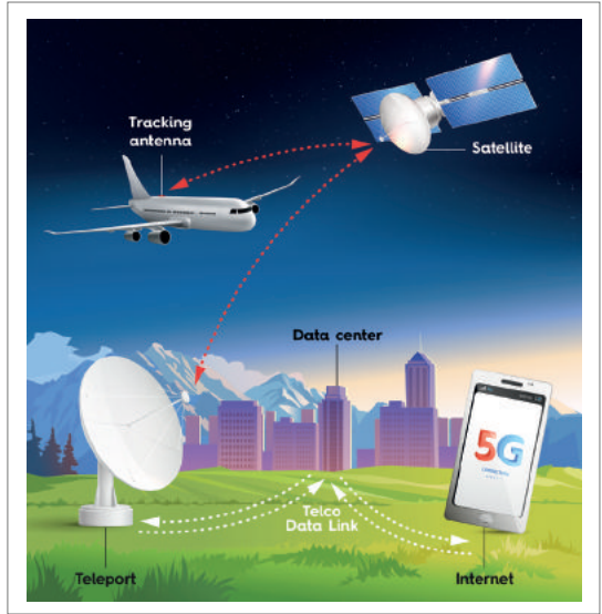
Fig. 165. Connectivité en vol par connexion satellitaire 443 .
