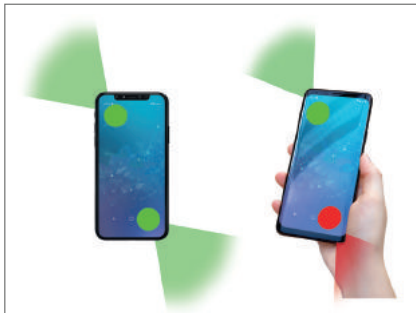
Fig. 13. Positionnement des antennes millimétriques dans le terminal 21 .
