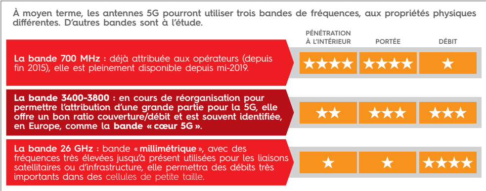
Fig. 68. Les bandes de fréquences envisagées pour les déploiements de la 5G en France 131 .
