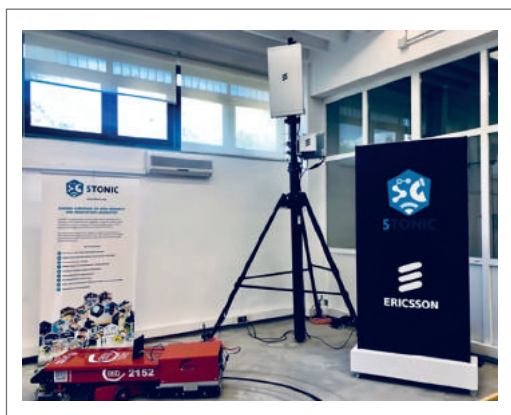
Fig. 172. Expérimentation de véhicules à guidage automatique grâce à la 5G 471 .
